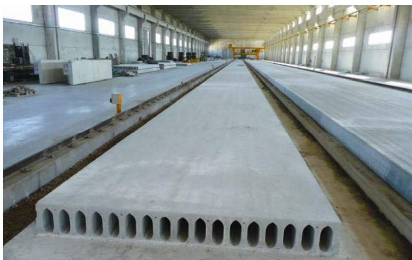
Proizvodnja prednapetih šupljih armiranobetonskih ploča
